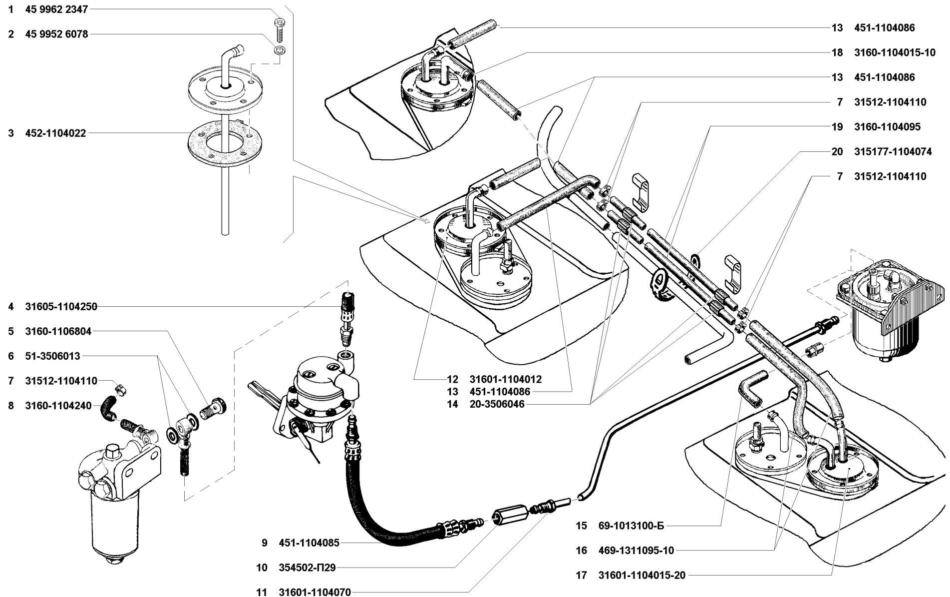
Рис. 18. Трубопроводы топливные (1104)/1
