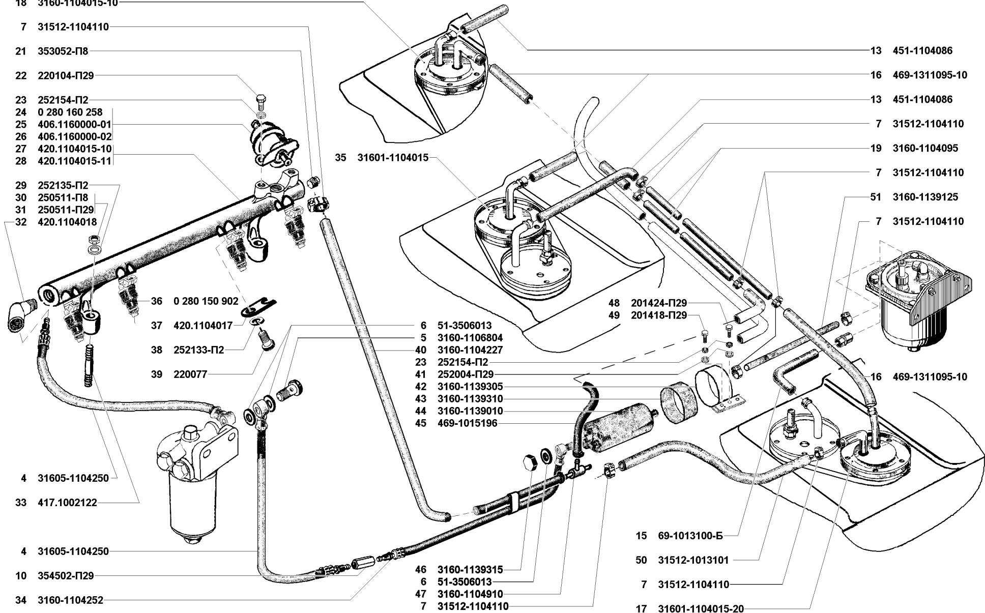
Рис. 19. Трубопроводы топливные (1104)/2, насос топливный низкого давления электрический (1139)
