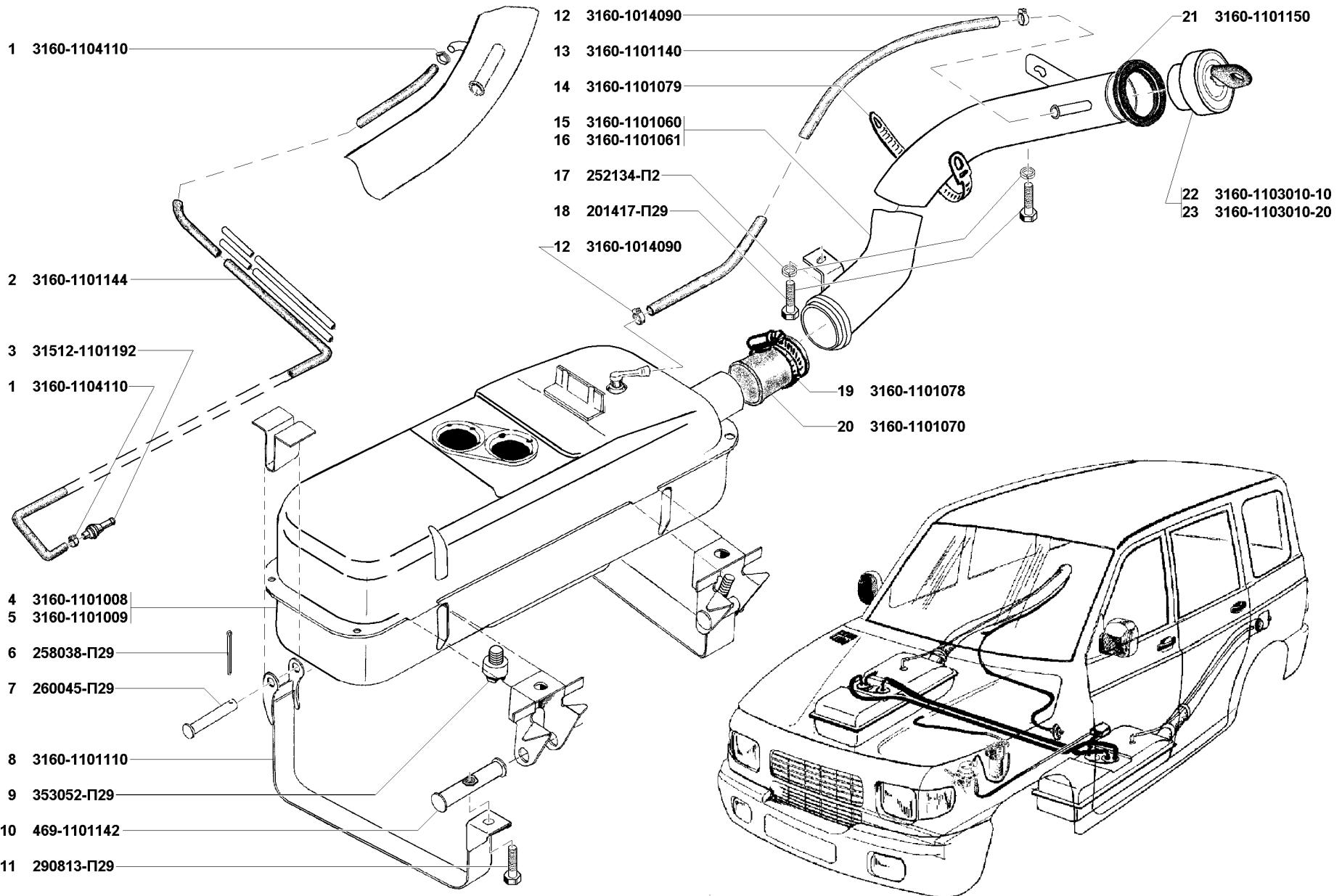
Рис. 17. Баки топливные (1101), пробка топливного бака (1103)
